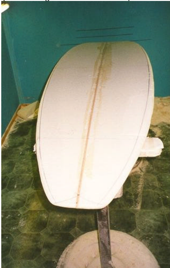
Abb. 5 Blank mit eingezeichneter Outline
