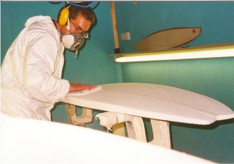
Abb. 10 Die Lauffläche wird mit dem Schleifklotz bearbeitet.
