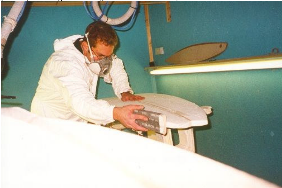
Abb. 7 Glätten der Kanten mit grobem Schmirgelpapier und Schleifklotz
