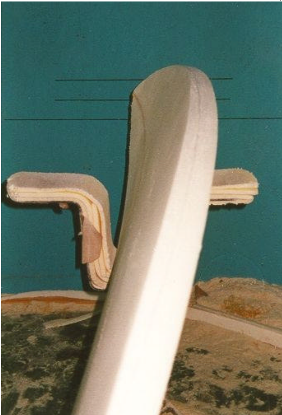
Abb. 11 Schwach zu erkennen: die Hilfslinie für das Rail
