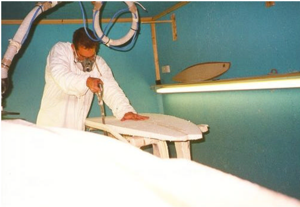
Abb. 6 Die Outline wird ausgesägt
