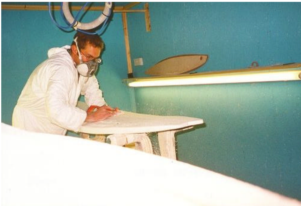
Abb. 9 Vom Deck wird Material mit der Surform Raspel abgetragen
