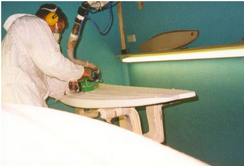
Abb. 8 Mit dem Elektrohobel wird das Brett auf die gewünschte Dicke gebracht
