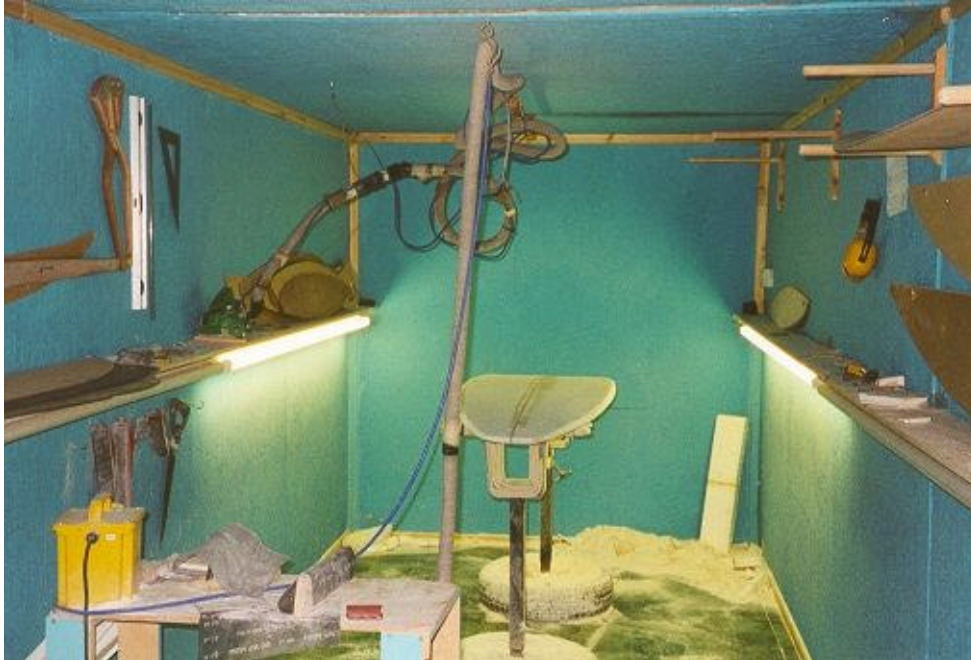
Abb. 2 Die Werkstatt eines Profis. In der Mitte das Blank wie es vom Produzenten kommt.
